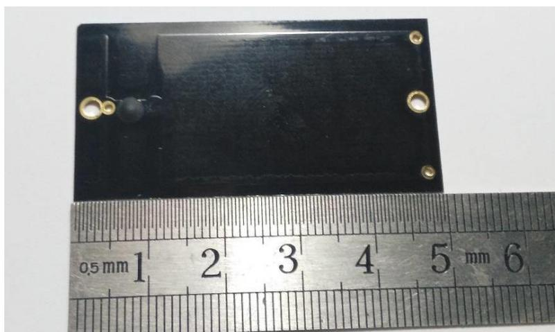
TAG-915-M5025-S 超薄抗金属标签，是专门为金属等复杂环境设计的一款小体积、轻薄、易安装的抗金属 RFID 电子标签。标签采用高性能 RFID 芯片和特殊的天线设计，具有阅读距离远，灵敏度高，物理特性优良的特点。其特有的天线设计与封装工艺，使其在轻薄化的基础上还保持有优良的射频性能，特别适合对安装体积有要求，又追求较高读取性能的场景。可应用但不限于金属资产管理、仓储货架、金属载具等场景中。
